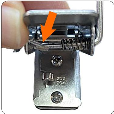
*example of bent slider plate*
